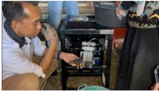
Gambar 1. Implementasi dan Pengujian Mesin Pemotong Otomatis Briket Arang pada Kelompok Tani Gattarareng
